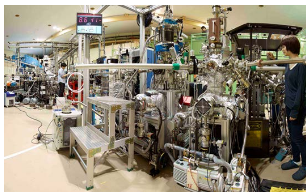
図4 BL-2Aに設置された「 in-situ 高分解能(角度分解)光電子分光・X線吸収分光装置」の写真。分子線エピタキシー装置などを接続し、作製した超構造の表面・界面の電子状態をその場で観測できる。写真では、レーザー分子線エピタキシー装置を接続し、作製した酸化物量子井戸構造の電子状態をその場で測定している。
